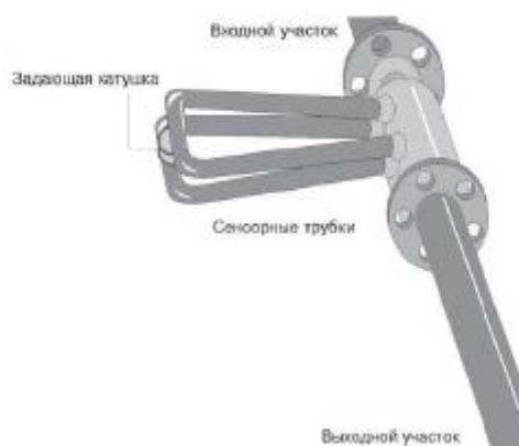
Сурет 1.3 - Кориолис шығын өлшеуішінің сызбасы
